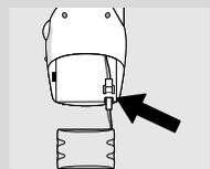
**3** Collegare con cautela la nuova batteria alla presa di alimentazione e sistemarla all'interno del vano.
