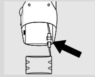
**3** Yhdistä uusi akku varovasti virtapistokkeeseen ja aseta se akkulokeroon.
