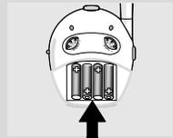
**2** Insérez quatre piles 1.5V LR6 (AA) en respectant les polarités + et - du compartiment des piles.
