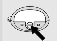
**1** Öffnen Sie den Batteriefachdeckel.
