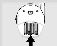
**2** Insertar cuatro pilas de 1,5V, tipo LR6 (AA) teniendo en cuenta la indicación de configuración de + y - dentro del compartimiento de pilas. Pilas no están incluidas; recomendamos las pilas de Alcalina no recargables de Philips.
