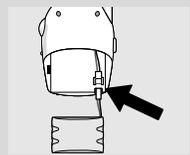
**3** Raccordez précautionneusement le nouveau bloc des piles à la fiche d'alimentation et installez le bloc dans le compartiment.
