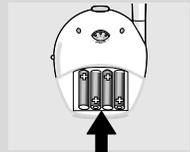
**2** Inserire quattro batterie da 1.5V, LR6 (AA) facendo attenzione a rispettare la polarità + e - indicate all'interno del vano.
