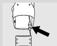
**3** Conectar con cuidado el nuevo paquete de pilas al tomacorriente y colocarlo dentro del compartimiento de pilas.
