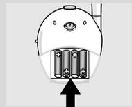
**2** Legen Sie vier 1,5V, LR6 (AA) Batterien unter Beachtung der korrekten Polung (+ und -) in das Batteriefach.
