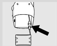
**3** Schließen Sie den neuen Batteriepack vorsichtig an den Stecker an und legen ihn in das Batteriefach.
